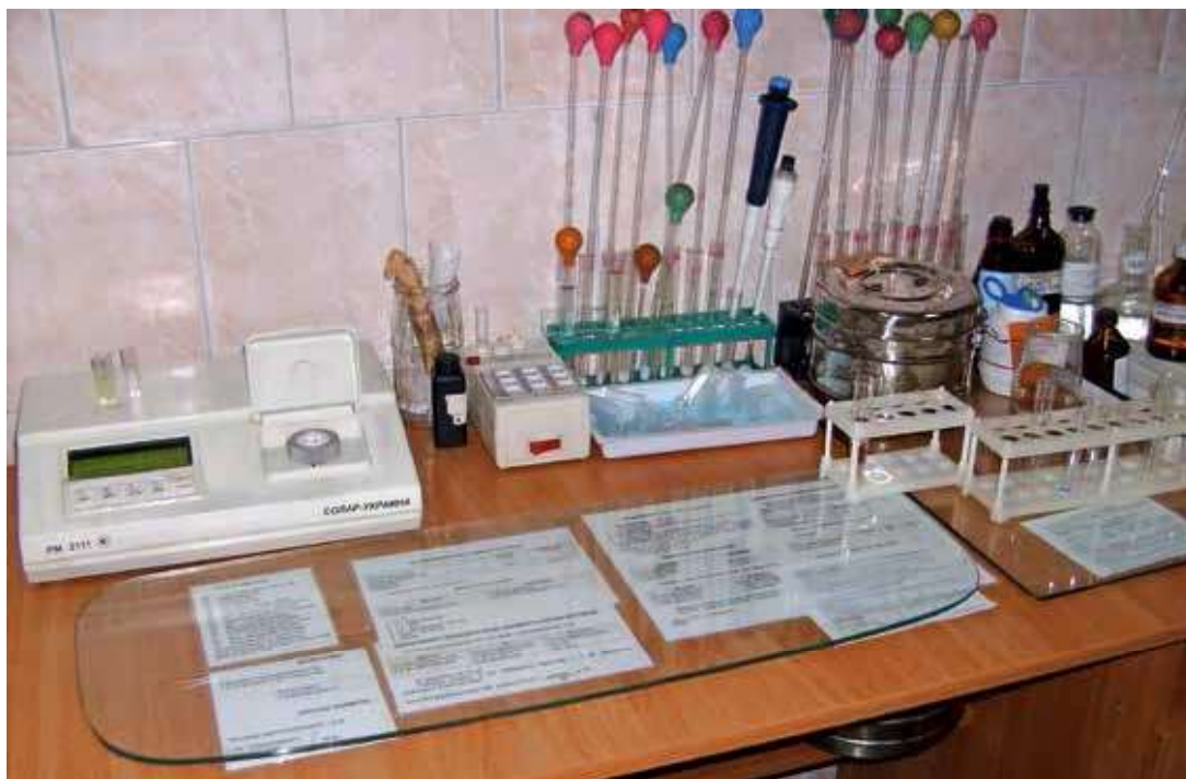
Laboratorieudstyr i akutlaboratoriet, diverse pipetter, på venstre side står et lille fotometer, og uden for billedet til højre ligger sugeslanger. "Forskrifter" ligger under glaspladen.
